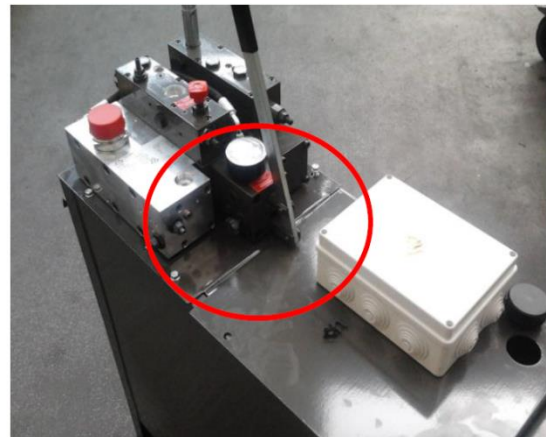
Fig. 15 – Impianti con valvola HDU integrata
