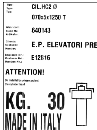
Fig. 3 – Matricola e targa di identificazione del cilindro
